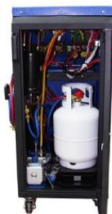
Полуавтоматическая установка предназначена для заправки автомобильных кондиционеров.
