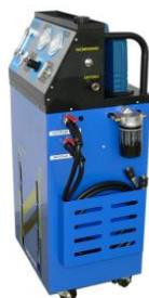
Предназначена для замены трансмиссионной жидкости в автоматических коробках передач автомобилей. Она является универсальной для большинства марок автомобилей и позволяет качественно и безопасно произвести полную замену старого масла на новое. Подключение оборудования производится за счет специальных переходников, входящих в стандартную комплектацию.
